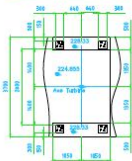
DETAÏL PLATINES Scelement platines avant pose
